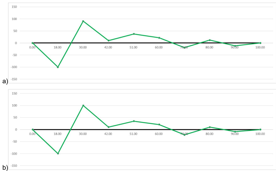
Rysunek 14. Szósta postać drgań własnych zidentyfikowana metodą CFDD punkty pomiarowe od strony a) Radzymińska b) Warszawy
