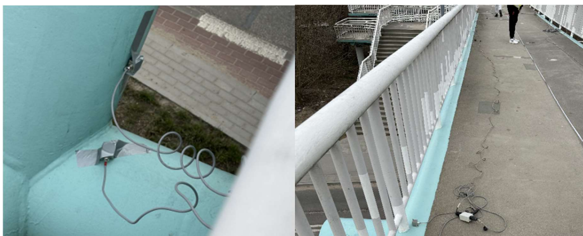
Fot. 52 Akcelerometry umieszczone na pylonie i dźwigarach
