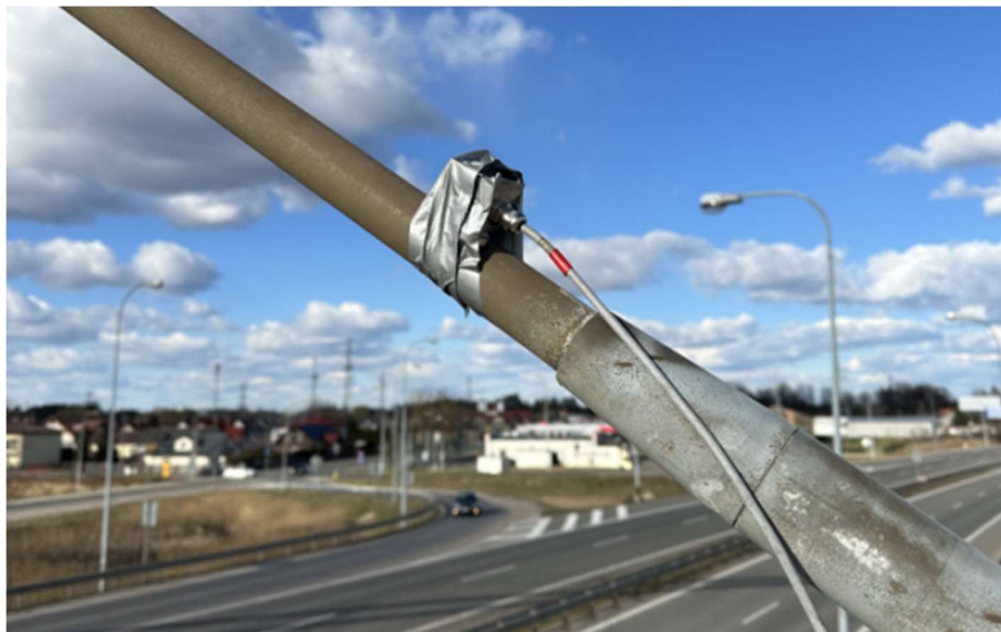
Fot. 51 Akcelerometr umieszczony na wancie
