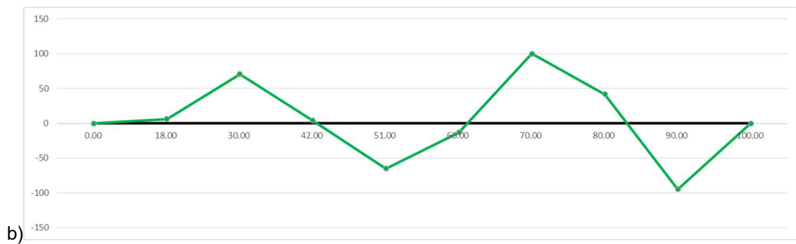
Rysunek 10. Czwarta postać drgań własnych zidentyfikowana metodą CFDD punkty pomiarowe od strony a) Radzymina b) Warszawy
